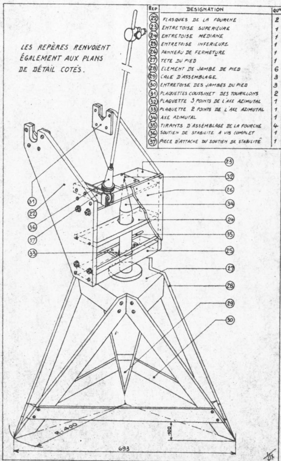
Fig. 60. — Ensemble du montage du pied azimuthal.
