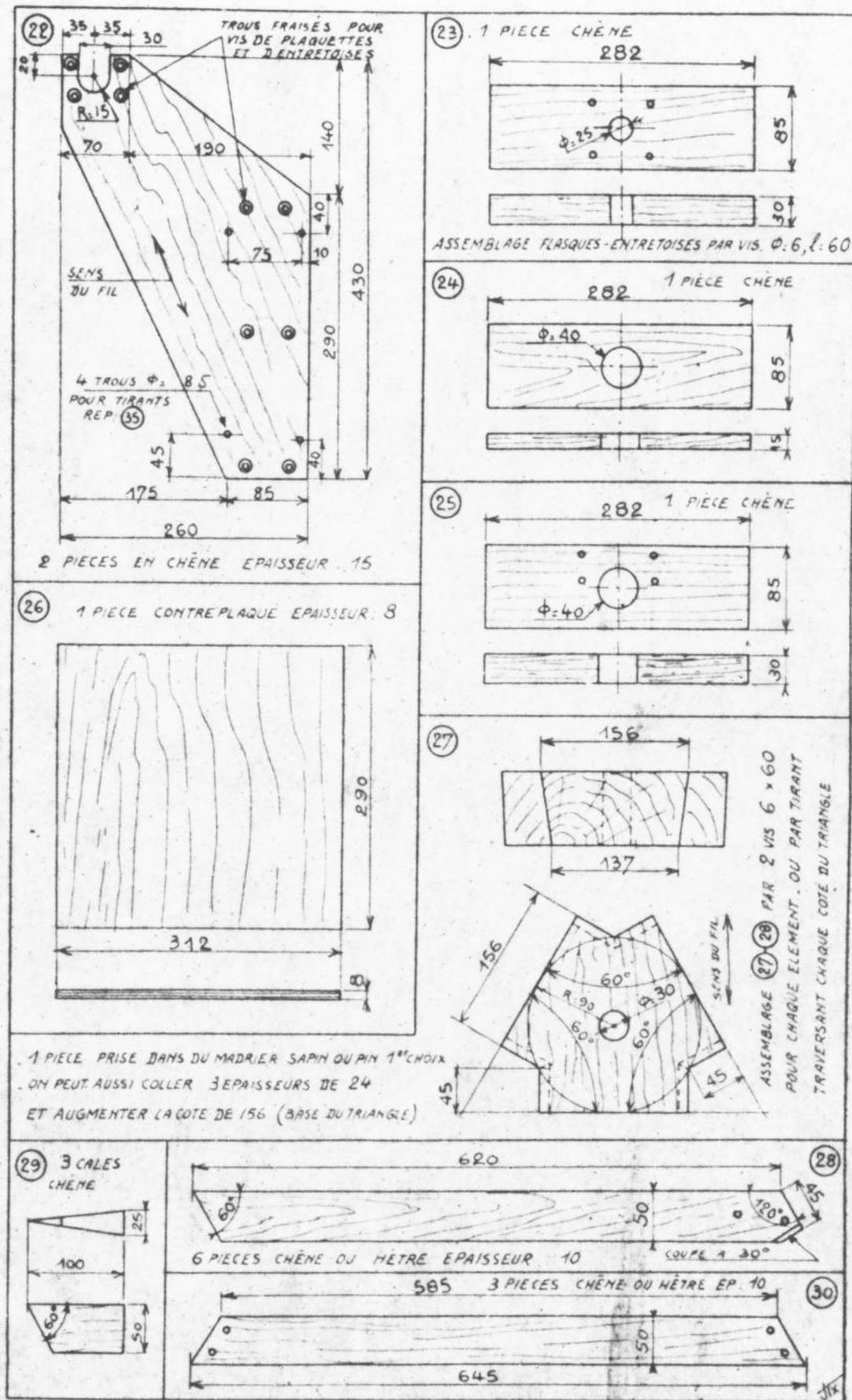
Fig. 61 — Pièces en bois du pied azimutal.
